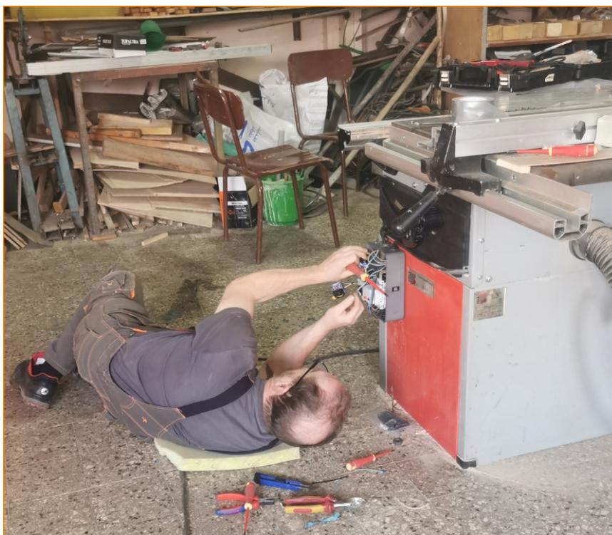
Im Oktober 2022 hatte Christian den **Schalter der Tischkreissäge** nur notdürftig instandsetzen können. Jetzt klemmte er einen neuen Schalter mit Motorschutzschalter an.
